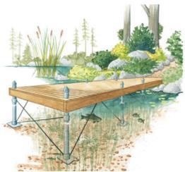
Les **quais sur pieds tubulaires** sont des structures amovibles supportées par des pieds (tiges) qui sont eux-mêmes déposés au fond du plan d'eau. Ce modèle de quai est le moins dommageable pour le milieu aquatique puisque la plateforme du quai est généralement située hors de l'eau. Par ailleurs, ce quai est particulièrement bien adapté aux plans d'eau agités en plus de permettre une taille inférieure à celle d'un quai flottant.
