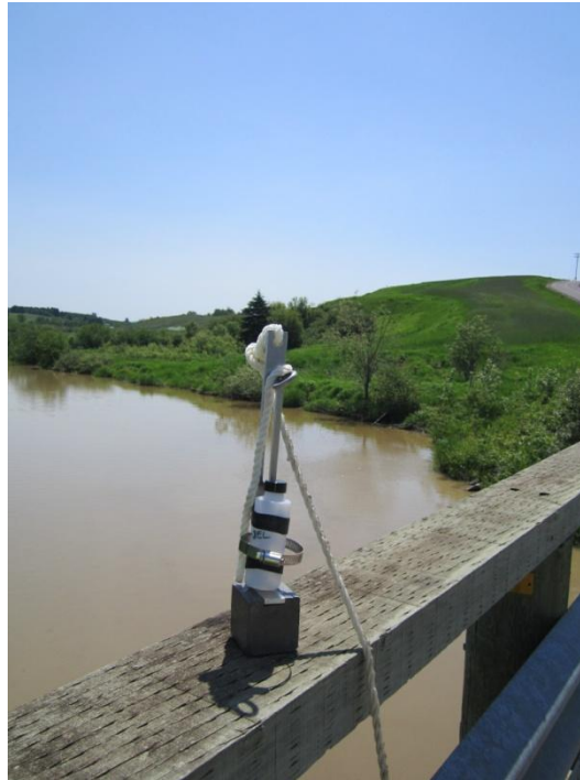
Figure 3: Échantillonneur lesté et bouteille utilisés pour l'échantillonnage depuis un pont (Station Belle-Rivière)
